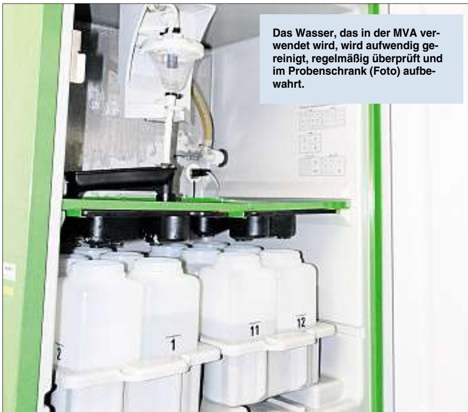
Das Wasser, das in der MVA verwendet wird, wird aufwendig gereinigt, regelmäßig überprüft und im Probenschrank (Foto) aufbewahrt.
